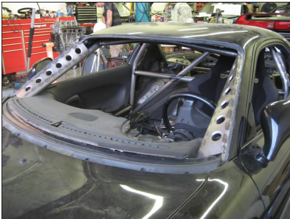
Элементы крепления каркаса безопасности к кузову.
